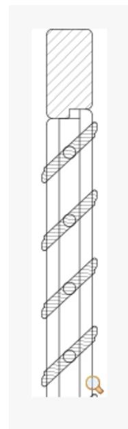
Ein Klappladen mit beweglichen Lamellen. Lüftung und Lichteinfall sind somit stufenlos regelbar. Die Verschlussstellung und Spaltlüftung kann fixiert werden. Selbstverständlich ist der Laden von der Außenseite nicht zu öffnen.
