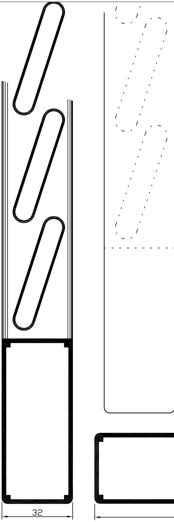
Der Laden wird erst nach dem Lackieren zusammengebaut. Dies hat den Vorteil, dass wenn eine Jalousie einmal beschädigt sein sollte, diese auch einzeln ausgetauscht werden kann. Die Lagerung der Jalousie ist so gewählt, dass sie zum Einen auf Grund von Temperatur-schwankungen im Rahmen arbeiten kann, dies aber zum Anderen recht geräuscharm von statten geht, da die Jalousien elastisch gelagert sind. Die Lamellen sind so gewählt, dass sie den statischen Anforderungen entsprechen.
