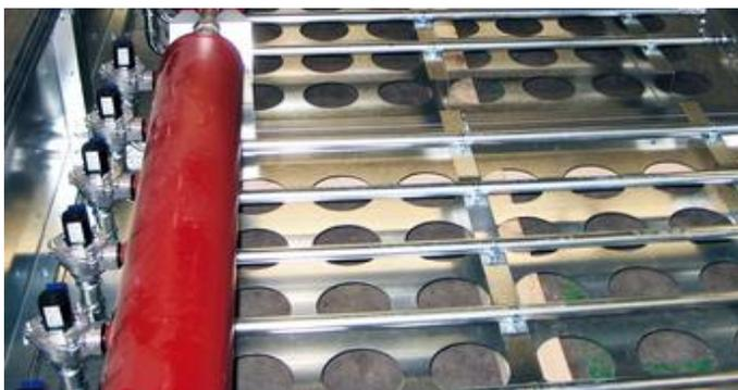
Links erkennt man das Entsorgungsgebläse mit den Filterschläuchen, den Druckbehälter der Gegendruckanlage, einen Filterschlauch und das Prinzip der Reinigung mit Hilfe des Luftdrucks entgegen der Absaugrichtung.
