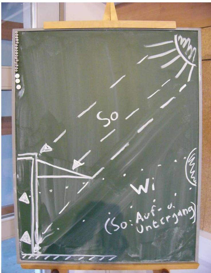
**Abb. 8: Prinzip der Sonnenschutzfunktion von Horizontalfaltssystemen;**
