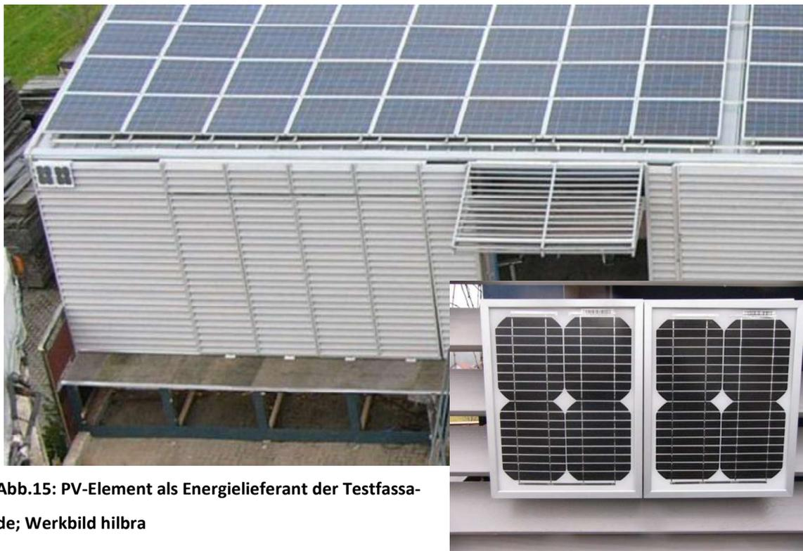
**Abb.15: PV-Element als Energielieferant der Testfassade; Werkbild hilbra**
